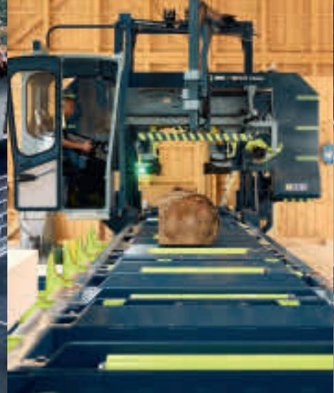
Die neue Säge verarbeitet Stämme von bis zu 15 m Länge und 1.4 m Durchmesser.
